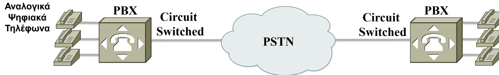
Σύνδεση μέσω δικτύου PSTN Παρόχου
